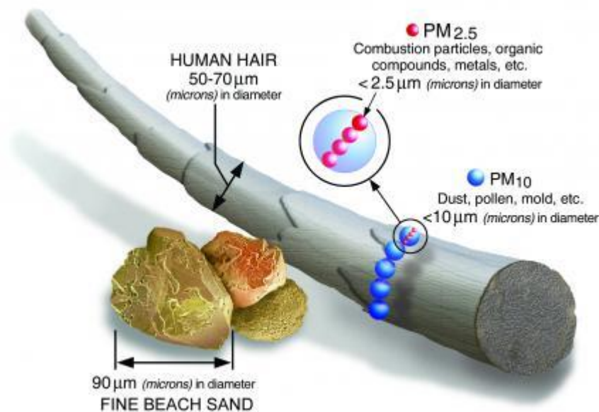
Εικόνα 7: Συγκριτικό μέγεθος σωματιδίων. Τα μέταλλα ανήκουν στην μικρότερη κλίμακα μεγέθους (US EPA, 2016)
