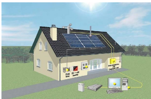
Εικόνα 3.1: Φωτοβολταϊκή εγκατάσταση σε στέγη.
