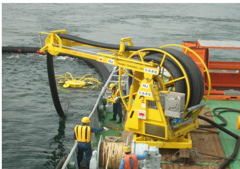
Εικόνα 4.10 ο εξοπλισμός TRANSREC 250 σε λειτουργία (πηγή: www.norwep.com )
