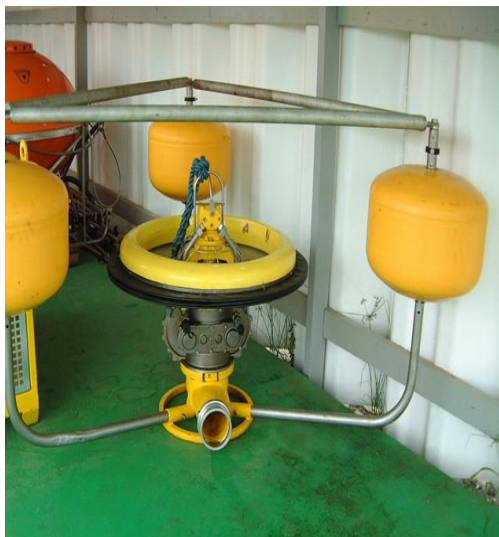
Εικόνα 2.7 η πλήρης εικόνα ενός weirskimmer (πηγή: www.cleanupoil.com )
