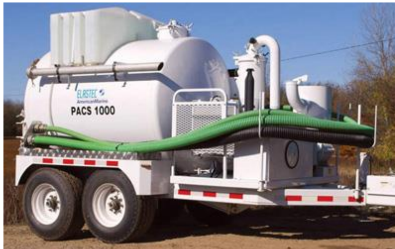
Εικόνα 2.14 η εικόνα από ένα όχημα κενού για το καθαρισμό ρυπασμένων επιφανειών (πηγή: www.spillpro.com.au )
