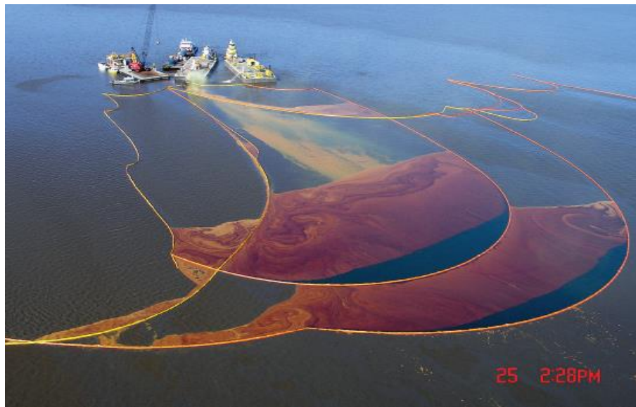
Εικόνα 2.4 η συγκράτηση πετρελαίου που διέρρευσε με φράγματα (πηγή: NOAA)
