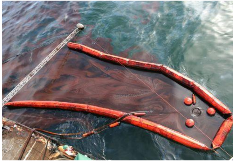
Εικόνα 2.5 η εγκατάσταση ενός skimmer μέσα στο φράγμα (πηγή: U.S. CoastalGuard)
