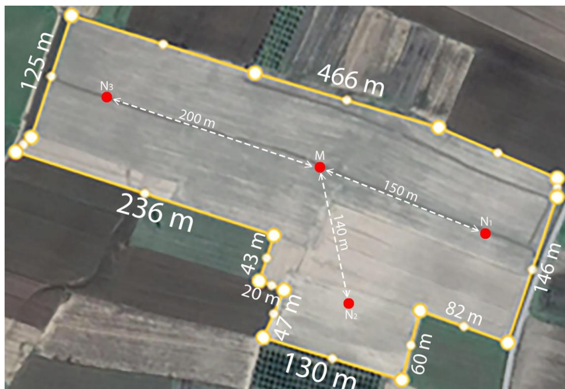
Εικόνα 5.3: Διάταξη αισθητήρων στον αγρό.
