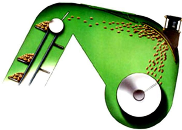
Εικόνα 2.2: Σύστημα μέτρησης ροής σπόρου Greenstar της John Deere.
