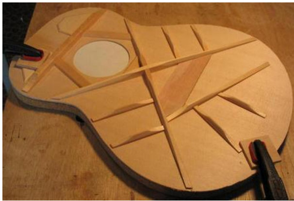
Εικόνα 2.3: Το εσωτερικό της κλασσικής κιθάρας. Όπως φαίνεται και στην εικόνα, τα καμάρια είναι τοποθετημένα σε σχήμα βεντάλιας (Link Νο6).
