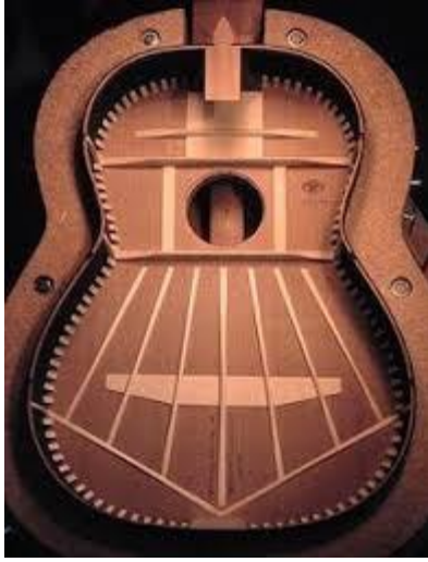
Εικόνα 2.3: Το εσωτερικό της κλασσικής κιθάρας. Όπως φαίνεται και στην εικόνα, τα καμάρια είναι τοποθετημένα σε σχήμα βεντάλιας (Link Νο6).
