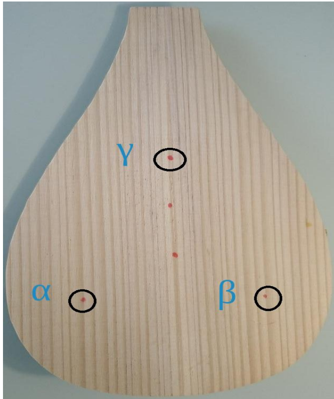
Εικόνα 5.2: Οι θέσεις που τοποθετήθηκε ο πιεζοηλεκτρικός κρύσταλλος κατά την ηχογράφιση.
