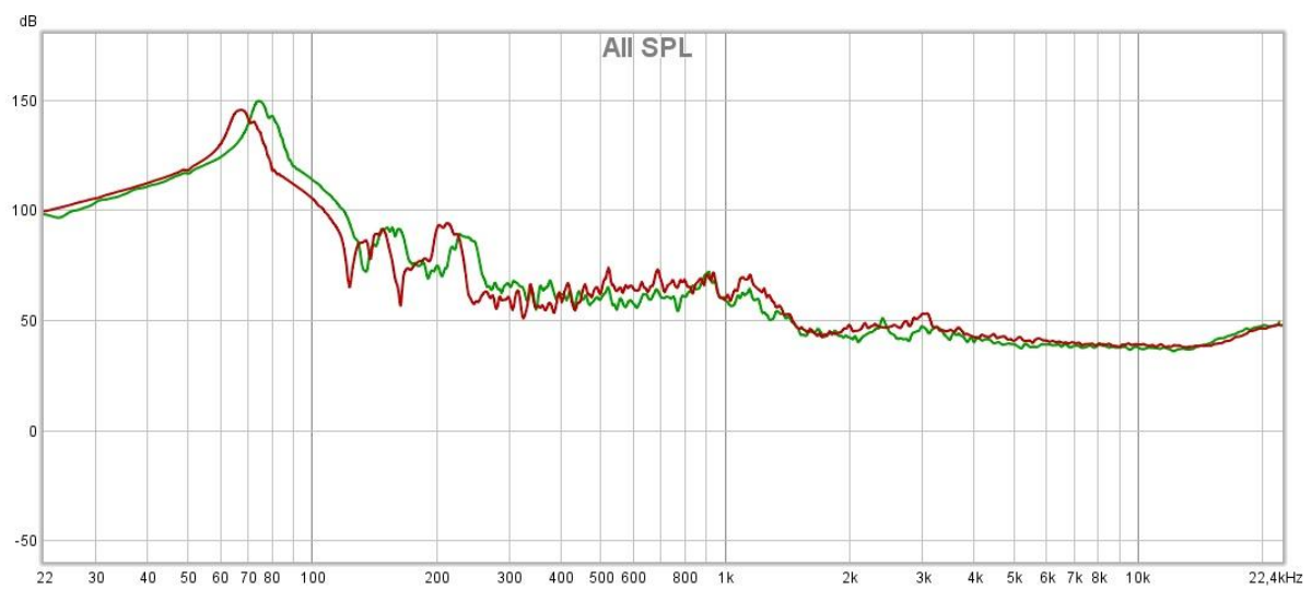
Γράφημα 6.3: Συχνотική απόκριση καπακιού 1, θέση κρυστάλλου κάτω δεξιά. Κόκκινο χρώμα πριν και πράσινο μετά την εμβάπτιση.
