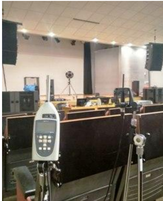
Εικόνα 2.3. : Ηχόμετρο και μετρητικό παντοκατευθυντικό μικρόφωνο
