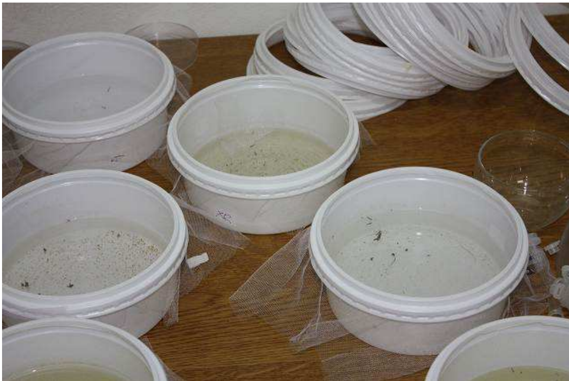
Εικόνα 20 : Δοχεία εκτροφής με κομμένο καπάκι και σήτα
