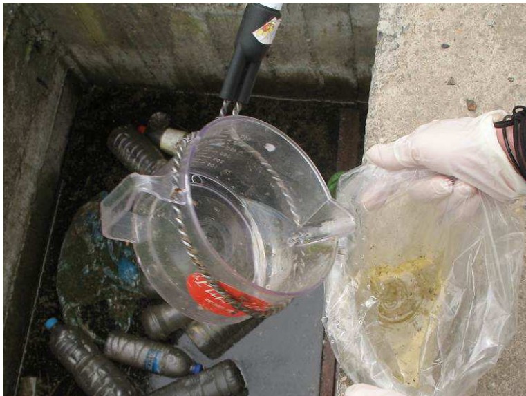
Εικόνα 18: Ο δειγματολήπτης που κατασκευάστηκε
