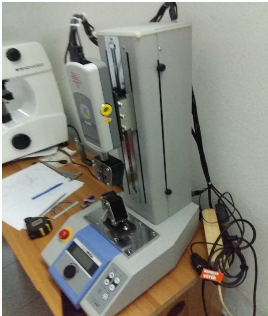
Εικόνα 7: Δύο εσοχές εφελκύνουν ένα δοκίμιο τραβώντας το μέχρι να καταστραφεί
