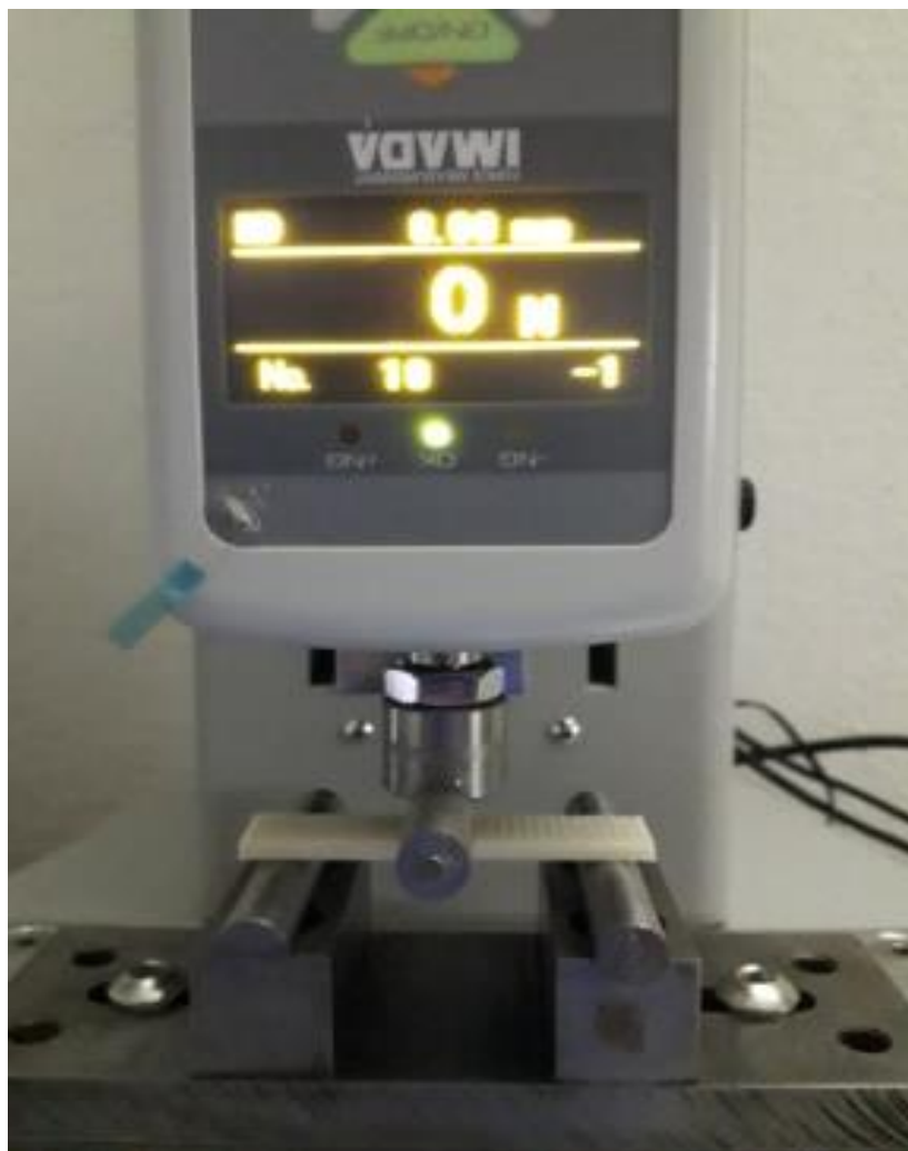
Εικόνα 17: Μηχανή Ιμάδα σε διάταξη δοκιμής κάμψης τριών σημείων με πλαστικό δοκίμιο
