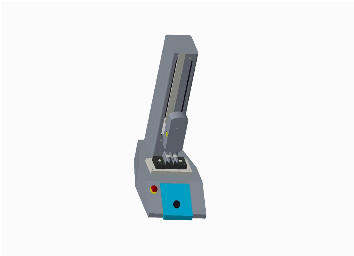
Εικόνα 34: Μηχανή Imada Force Measurement σε διάταξη κάμψης με δοκίμιο
