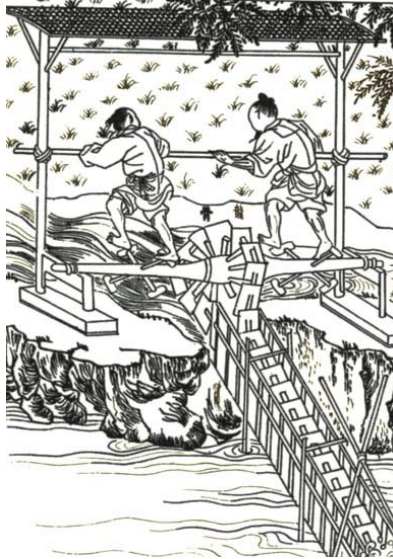
Εικόνα 24 Μεταφορά νερού με το σύστημα οδοντωτού τροχαίου
