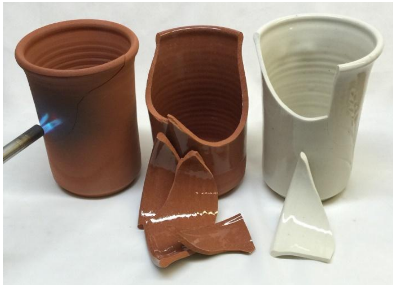
Εικόνα 15: Αστοχία λόγω θερμικού σοκ
