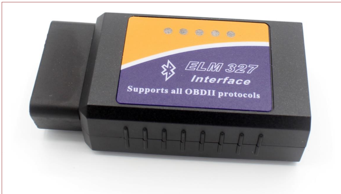
Εικόνα 13: Συσσκευή λήψης δεδομένων ( ELM 327 – OBD 2 ).
