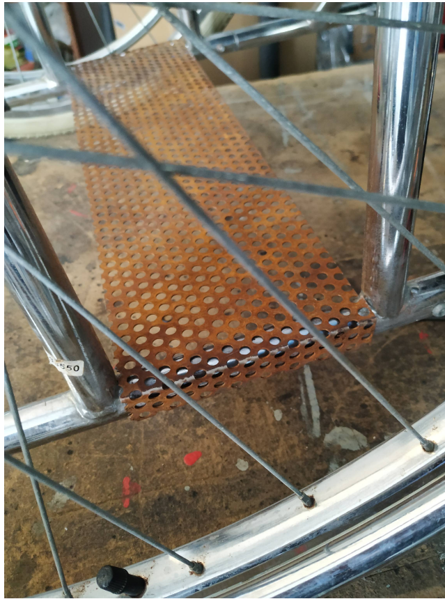
Εικόνα 78: Προσαρμογή ακριβώς στις διαστάσεις των κυκλικών δοκών του αμαξιδίου.
