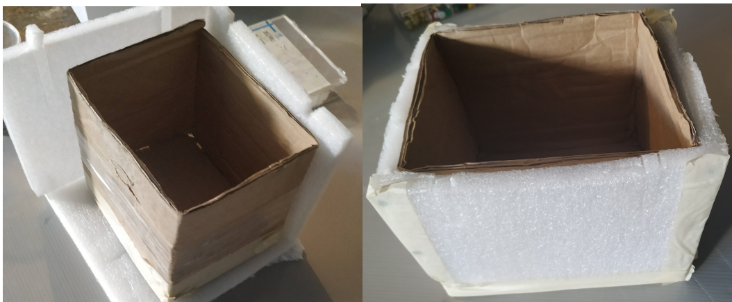
Εικόνα 45: Κατασκευή του δεύτερου καλουπιού.
