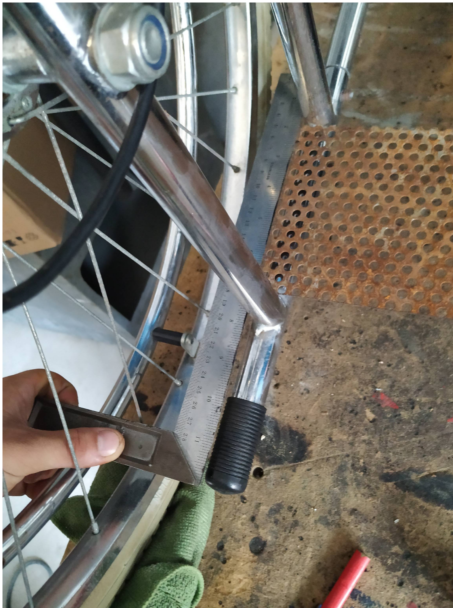
Εικόνα 76: Στιγμή από τη διαδικασία του «γωνιάσματος» της βάσης.
