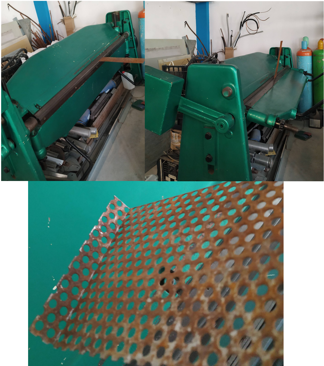
Εικόνα 77: Στιγμή από το «στραντζάρισμα» της διάτρητης λαμαρίνας για την κατασκευή ορθής γωνίας.
