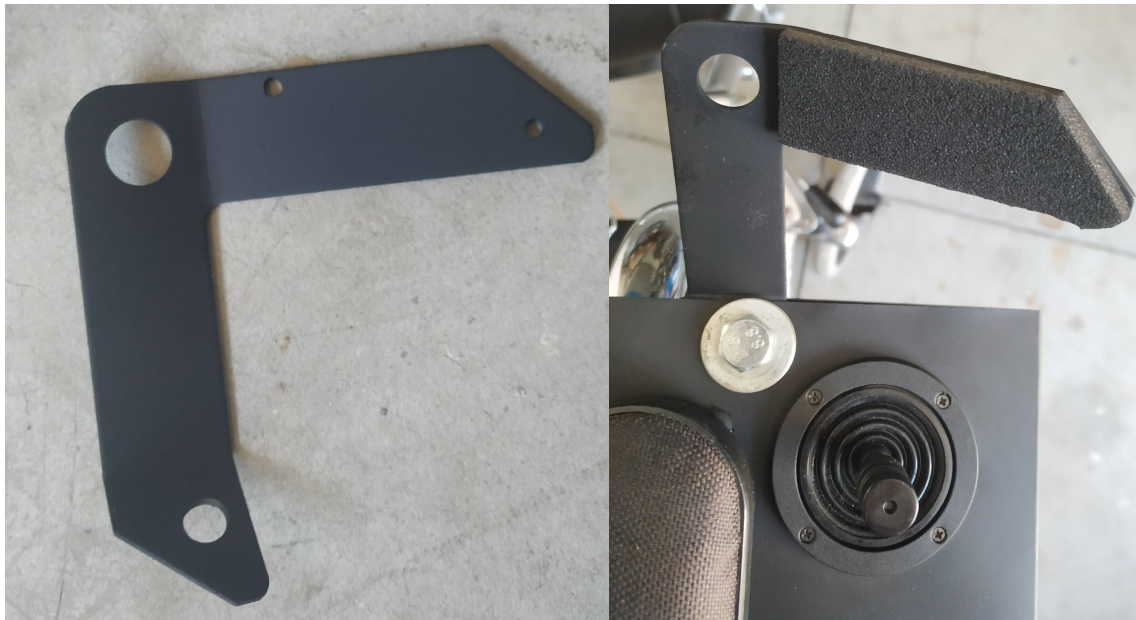
Εικόνα 91: Βαφή της βάσης της οθόνης επιλογών με μαύρο ματ σπρέι και τοποθέτηση αφρώδους μονωτικού υλικού.
