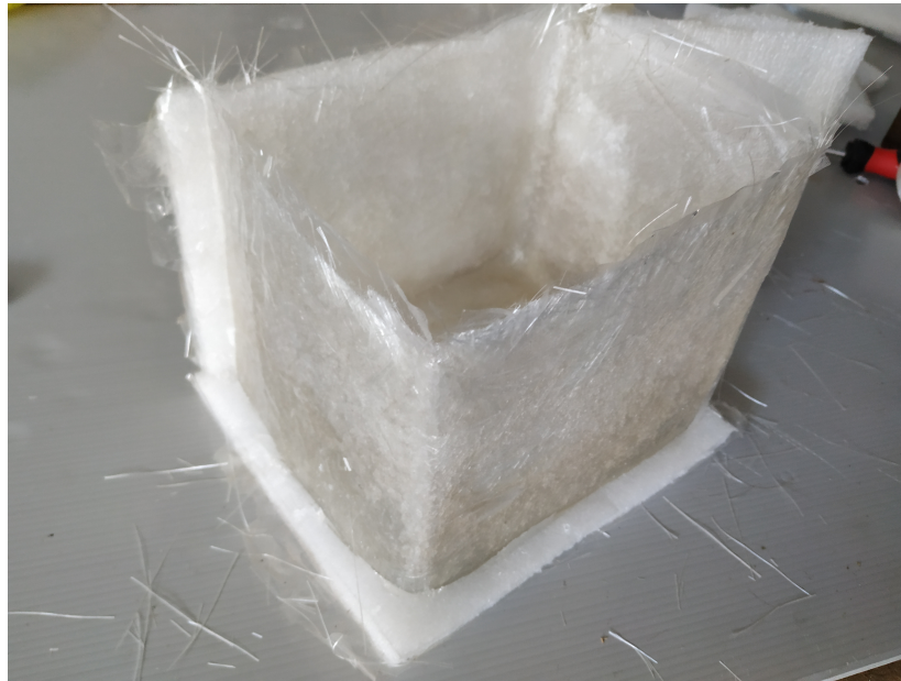
Εικόνα 49: Αφαίρεση του καλουπιού από την θήκη.
