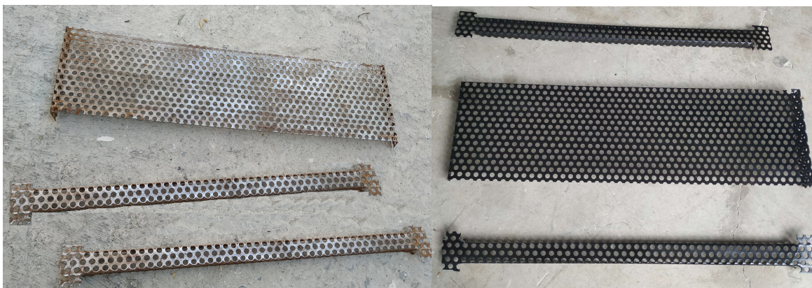
Εικόνα 80: Η βάση μαζί με τα δύο «νεύρα» μετά από βαφή και αφαίρεσης σκουριάς με γυαλόχαρτο.
