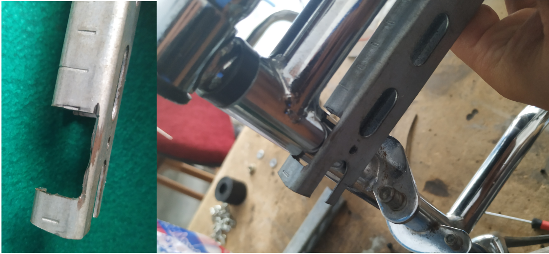
Εικόνα 57: Εσοχή για την προσαρμογή στη δοκό του αμαξιδίου.
