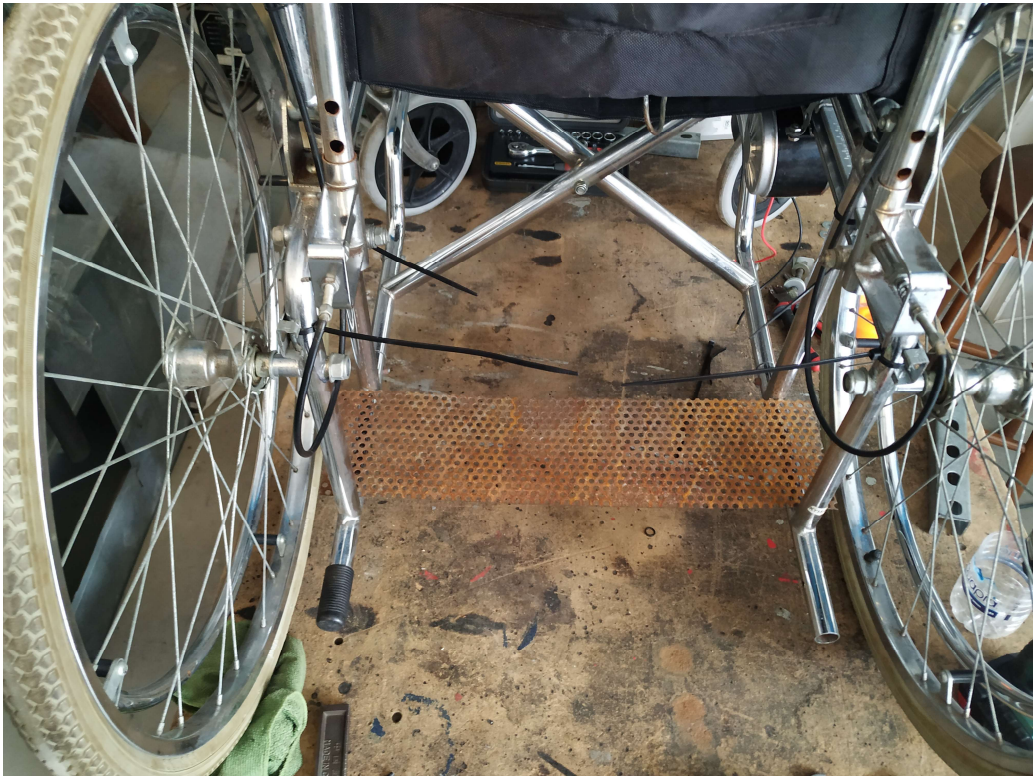
Εικόνα 75: Η θέση στην οποία θα τοποθετηθεί η βάση των συσσωρευτών.
