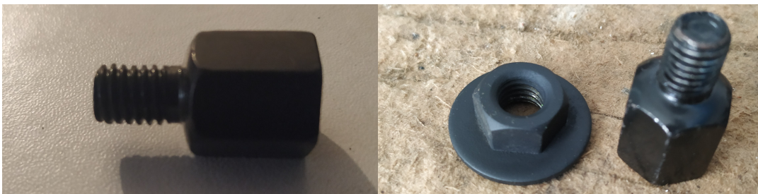
Εικόνα 70: Αριστερά διακρίνεται ο μετατροπέας από αριστερό σε δεξιό σπείρωμα και στα δεξιά μαζί με το περικόχλιο που θα ασφαλίσει την τροχαλία στην θέση της.
