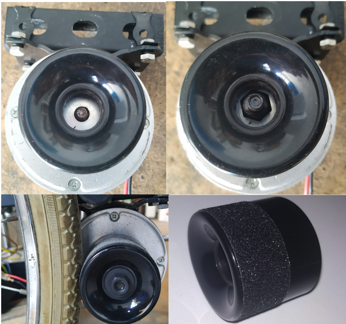
Εικόνα 71: Τοποθέτηση της τροχαλίας επάνω στον άξονα του κινητήρα.
