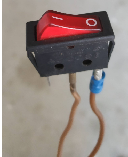
Εικόνα 88: Ο γενικός διακόπτης του οχήματος.
