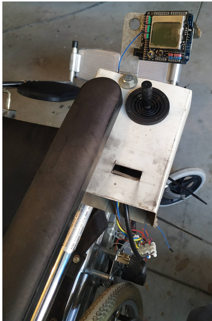
Εικόνα 89: Τοποθέτηση της οθόνης επιλογών και του χειριστηρίου επάνω στην κονσόλα.
