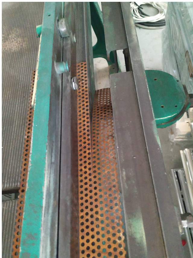
Εικόνα 79: Κοπή διάτρητης λαμαρίνας για την κατασκευή «νεύρου» σε λαμαρινοψάλιδο.
