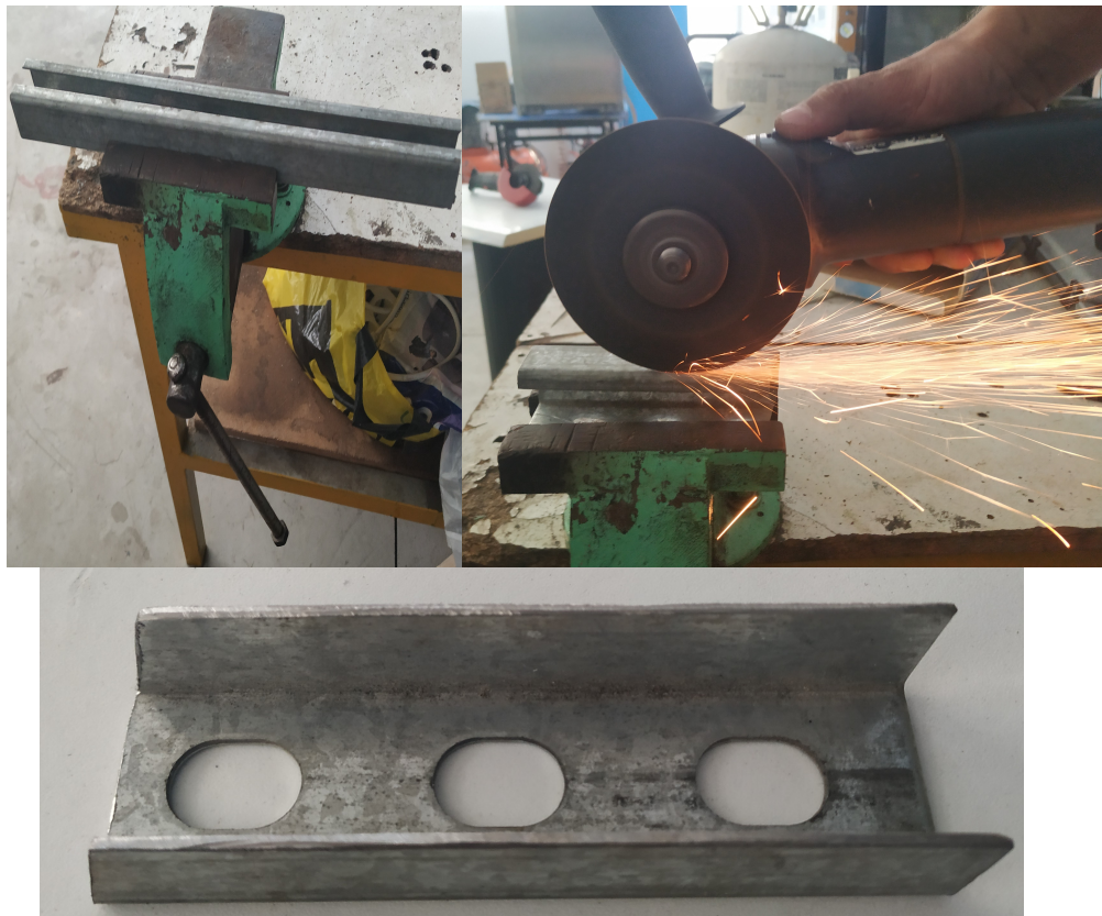
Εικόνα 60: Δέσιμο της κινούμενης ράγας στην μέγγενη και κοπή των «αυτιών» με γωνιακό τροχό.
