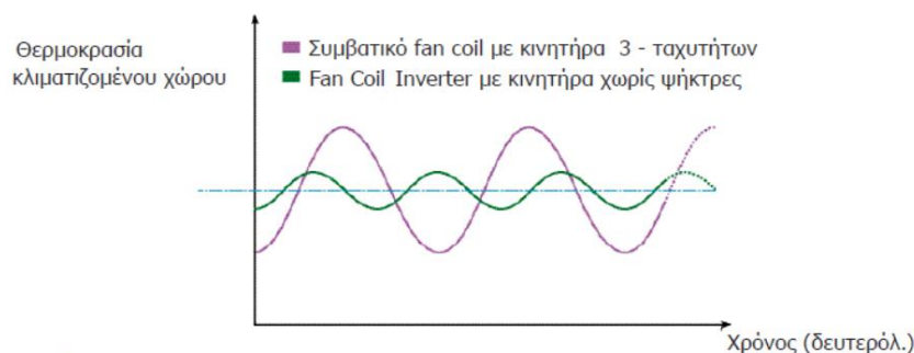
Σχήμα 5.6 : Διάγραμμα σύγκρισης επιθυμητής λειτουργίας συμβατικού και inverter Fan Coil [21]
