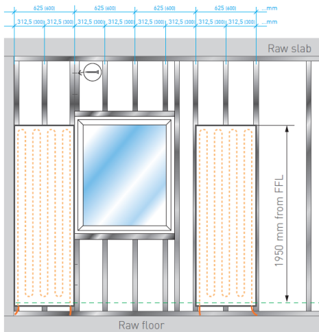
Σχήμα 3.33 : Μεταλλική βάση στήριξης του πάνελ τοίχου με τις προτεινόμενες διαστάσεις [10]
