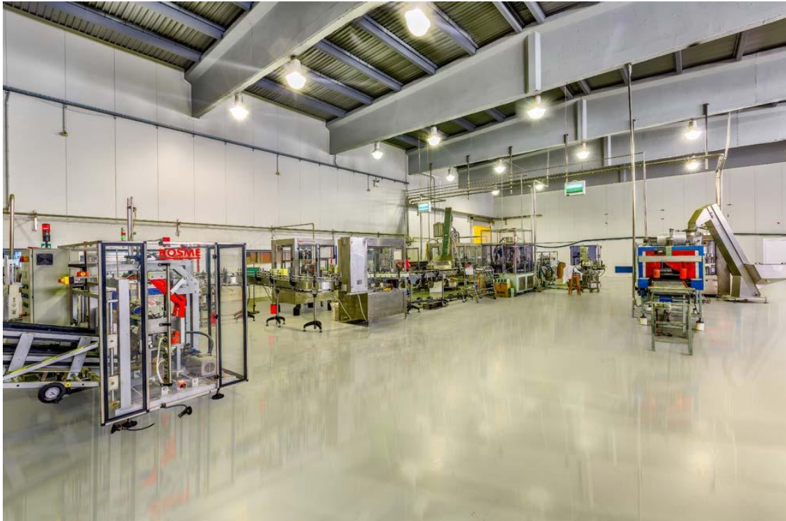
Εικόνα 4. Γραμμές τυποποίησης ελαιολάδου από τις εγκαταστάσεις της Ε.Α.Σ. Ηρακλείου. (διακρίνεται η γραμμή τυποποίησης γυάλινης φιάλης στα αριστερά, η γραμμή τυποποίησης πλαστικής φιάλης στο κέντρο και η γραμμή τυποποίησης μεταλλικών δοχείων στα δεξιά).
