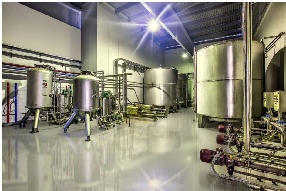
Εικόνα 2..Χώρος φιλτραρίσματος ελαιολάδου από τις εγκαταστάσεις της Ε.Α.Σ. Ηρακλείου. (Αριστερά διακρίνονται τα φίλτρα «γης διατομών», δεξιάτετα οι «φιλτρόπρεσες» και οι δεξαμενές προσωρινής αποθήκευσης του διαυγασμένου ελαιολάδου).
