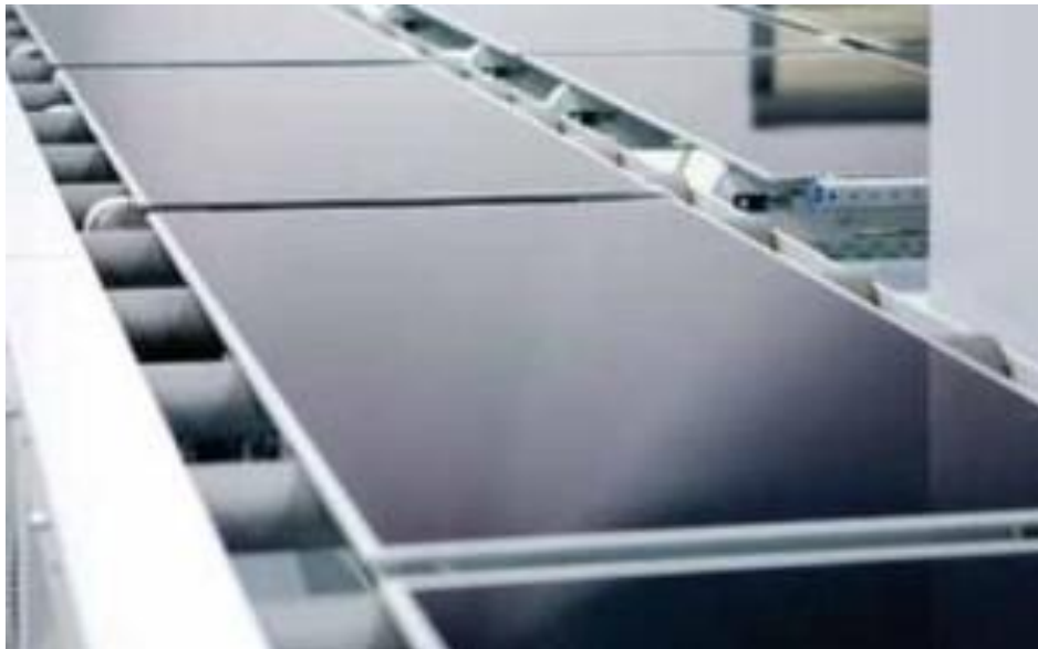
Εικόνα 2.5: Παραγωγή πλαισίων Τελουριούχου Καδμίου (CdTe)
