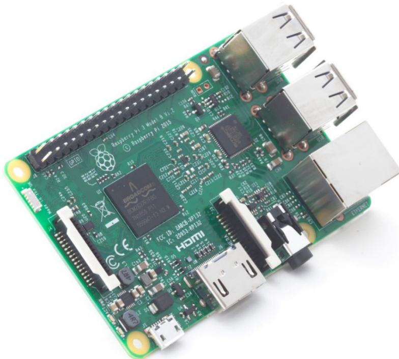
Σχήμα 33. Η Μικροϋπολογιστική πλατφόρμα Raspberry Pi 3 Model B.[12]
