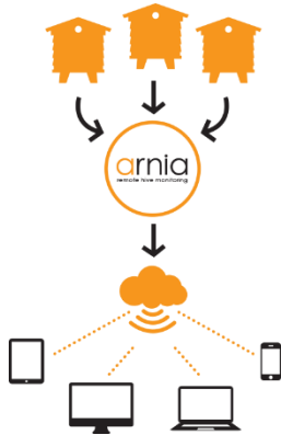
Εικόνα 19 : Αρχιτεκτονική του συστήματος Arnia
