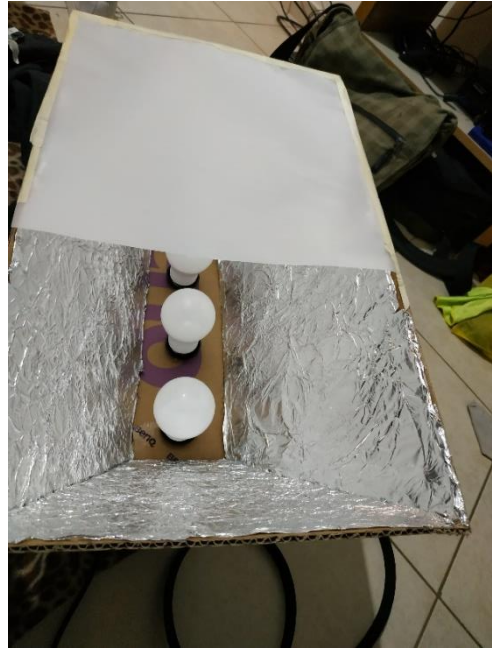
Εικόνα 16 - Το εσωτερικό της κατασκευής. Διακρίνονται οι λάμπες LED καθώς και η ανακλαστικές επιφάνειες.
