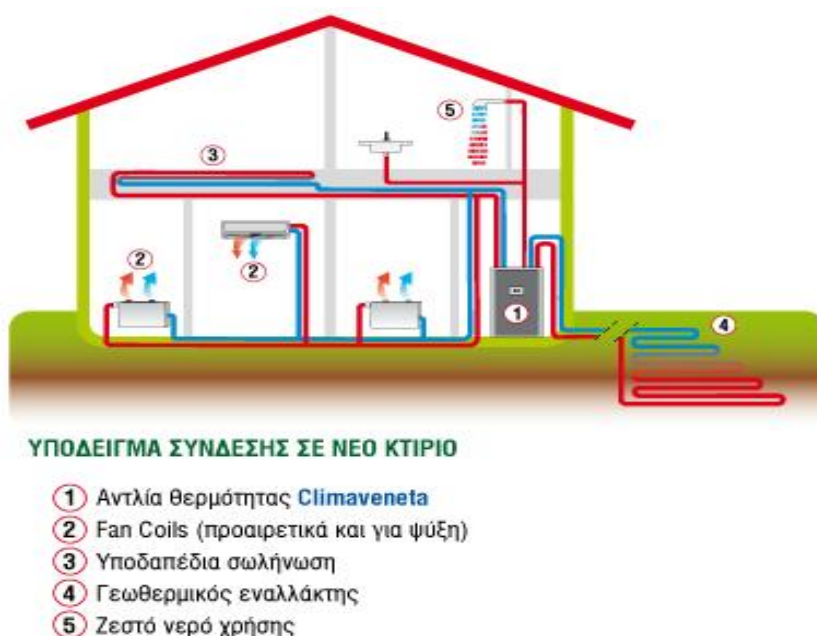
Εικόνα 2.8 «Σύνδεση – εγκατάσταση γεωθερμικού συστήματος»
