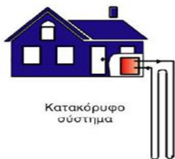
Εικόνα 2.5. «Κατακόρυφο κλειστό γεωθερμικό σύστημα»
