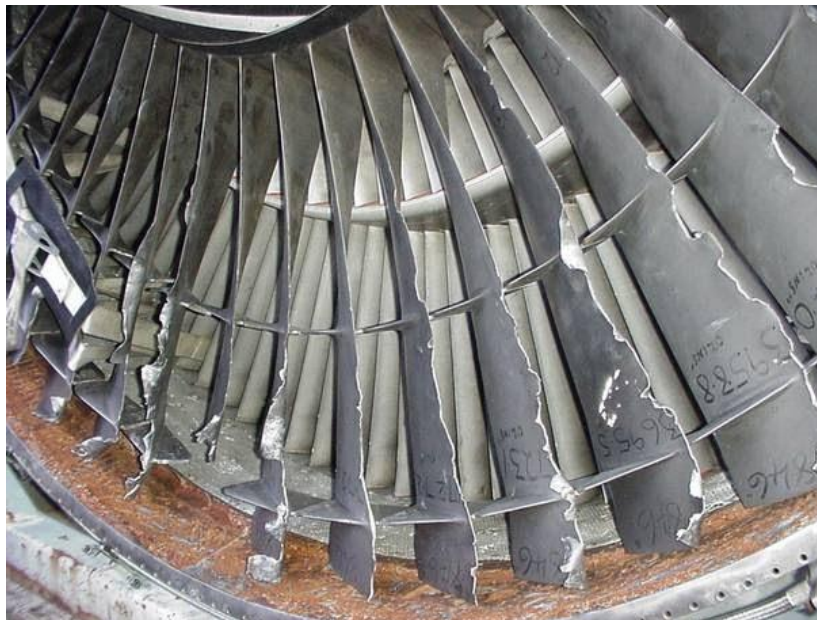
Εικόνα 3.2 Ζημιά από FODs στην είσοδο κινητήρα αεροσκάφους
