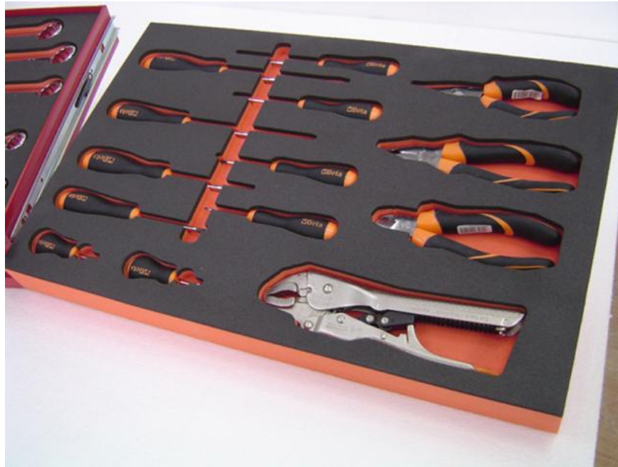
Εικόνα 6.3 Διαμόρφωση του εργαλειοφόρου με χρήση foam
