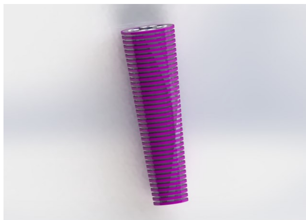
Εικόνα 18 Δακτύλιοι συγκράτησης και καθοδήγησης ελικοειδούς μυϊκού συστήματος
