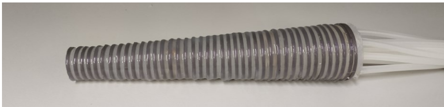
Εικόνα 26 Ολοκληρωμένος βραχίονας με παράλληλο μυϊκό σύστημα.
