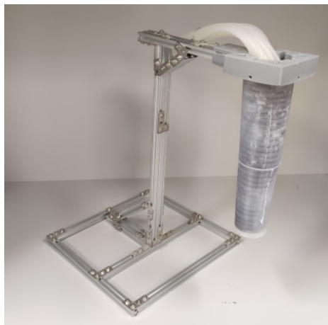
Εικόνα 12 Ο βιομημητικός ρομποτικός βραχίονας μαλακών υλικών που αναπτύχθηκε στα πλαίσια της παρούσας εργασίας.
