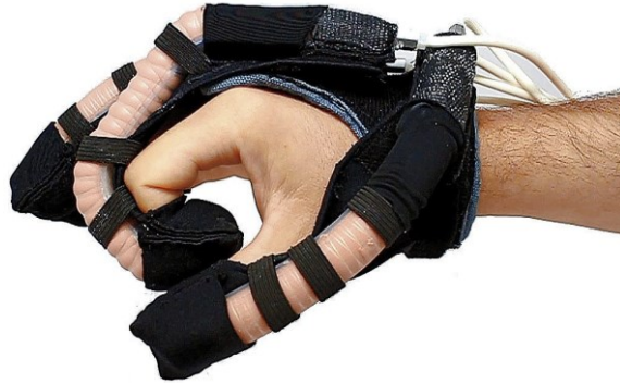
Εικόνα 6 Εξωσκελετικός νάρθηκας με χρήση μαλακών υλικών των Polygerinos et.al [6]
