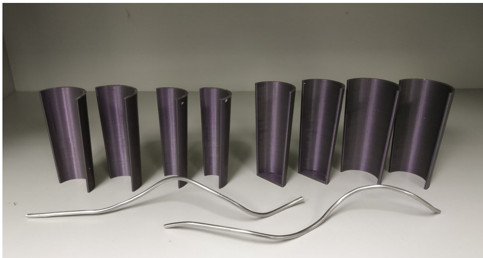
Εικόνα 22 Καλούπια χύτευσης ελικοειδούς μυϊκού συστήματος.
