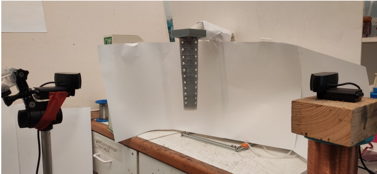
Εικόνα 69 Πειραματική διάταξη βιομμητικού ρομποτικού βραχίονα ελεγχου κλειστού βρογχου.
