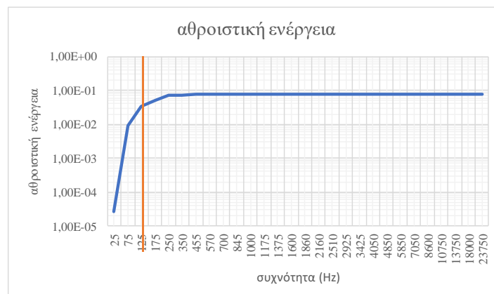
Σχήμα 8: Αθροιστική ενέργεια ως προς τη συχνότητα. Το φασματικό roll-off εντοπίζεται στα 125 Hz
