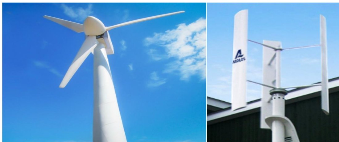
Εικόνα 3.1 (Αριστερά) Α/Γ οριζόντιου άξονα, (Δεξιά) Α/Γ κατακόρυφου άξονα.
