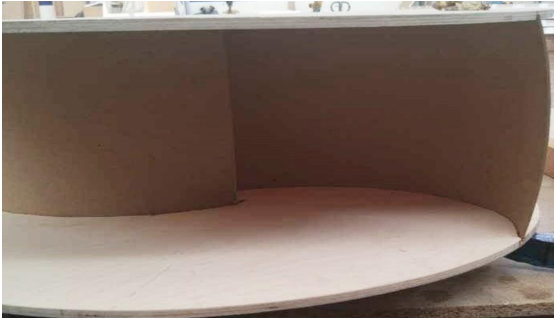
Εικόνα 5.6 Κατασκευή της ανεμογεννήτριας
