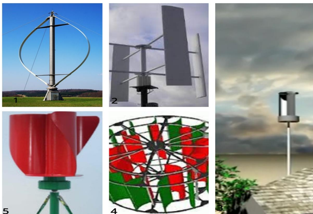
Εικόνα 5.2 1: Α/Γ τύπου Darrieus 2: Α/Γ τύπου Gyromill Darrieus 3 : Α/Γ τύπου Savonius 4: Α/Γ τύπου Statocoolien 5: Α/Γ τύπου turbine (ελικοειδές)
