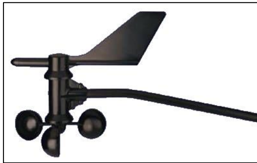
↑↑ Εικόνα 3.3: Ανεμοδείκτης και ανεμόμετρο σε συνδυασμό. ↑↑
