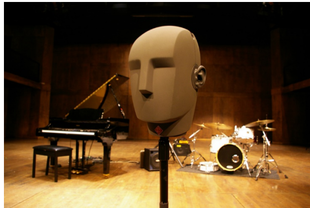
Εικόνα 2.14 Προσομοίωση ανθρώπινης κεφαλής της Binaural τεχνικής.
