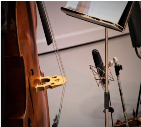
Εικόνα 5.20 μικρόφωνο Neumann U89 πολικού διαγράμματος καρδιάς για την λήψη δύο κόντρα μπάσων
