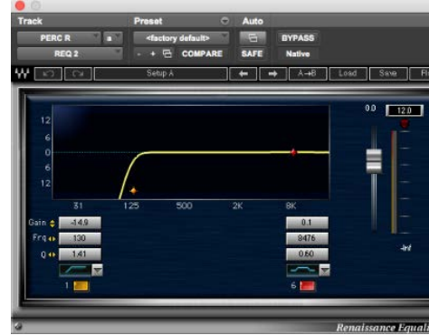
Εικόνα 6.7.β χρήση low cut φίλτρου στο δεξί κανάλι των κρουστών
