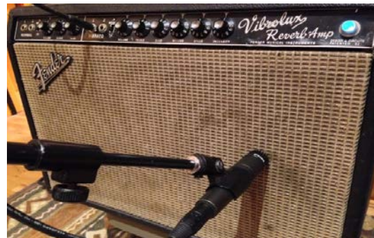
Εικόνα 2.2 Τοποθέτηση μικροφώνου κοντά στην πηγή
