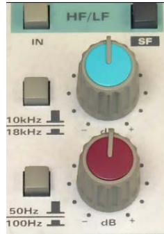
Εικόνα 4.1.6 Shelving EQ χαμηλών και υψηλών συχνοτήτων της κονσόλας μίξης Audient ASP 8024
