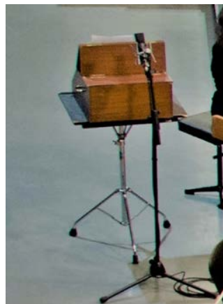
Εικόνα 5.23 τοποθέτηση μικροφώνου Neumann U89 πολικού διαγράμματος καρδιάς στο Glockenspiel
