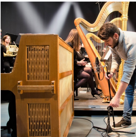
Εικόνα 5.22 τοποθέτηση μικροφώνου Neumann U89 πολικού διαγράμματος καρδιάς στην τσελέστα
