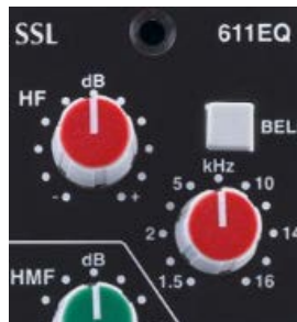
Εικόνα 4.1.7 Shelving EQ υψηλών συχνοτήτων SSL 611
