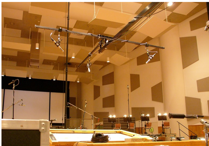
Εικόνα 2.13 Διάταξη της τεχνικής Decca Tree με τρία μικρόφωνα.
