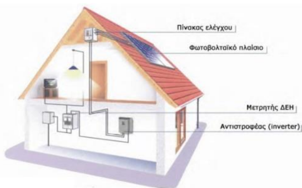
Εικόνα 33 Διασυνδεδεμένο σύστημα (Πηγή http://helapco.gr )
