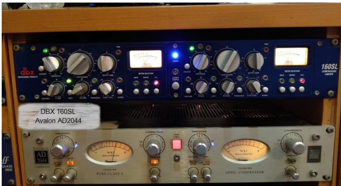
Εικόνα 14: Μέρος του Rack 2 στο οποίο διακρίνονται οι Συμπιεστές DBX 160SL (επάνω) και Avalon AD2044 (κάτω)
