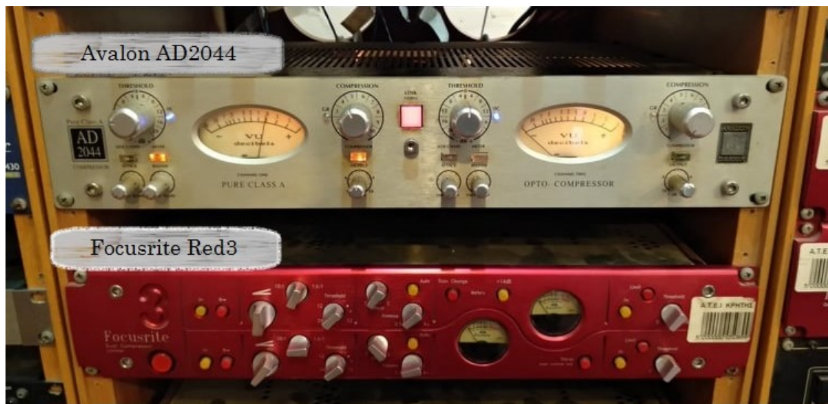
Εικόνα 15: Μέρος του Rack 2 στο οποίο διακρίνονται οι Συμπιεστές Avalon AD2044 (επάνω) και Focusrite Red 3 (κάτω)
