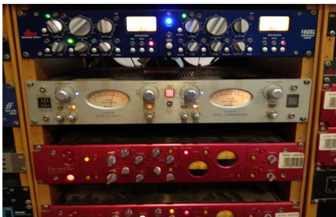
Εικόνα 13: Το Rack 2 των περιφερειακών συσκευών του Studio στο οποίο βρίσκονται εγκατεστημένοι και οι 3 Συμπιεστές μαζί (στο κάτω μέρος της εικόνας διακρίνεται και η δεύτερη μονάδα Focusrite Red 3).
