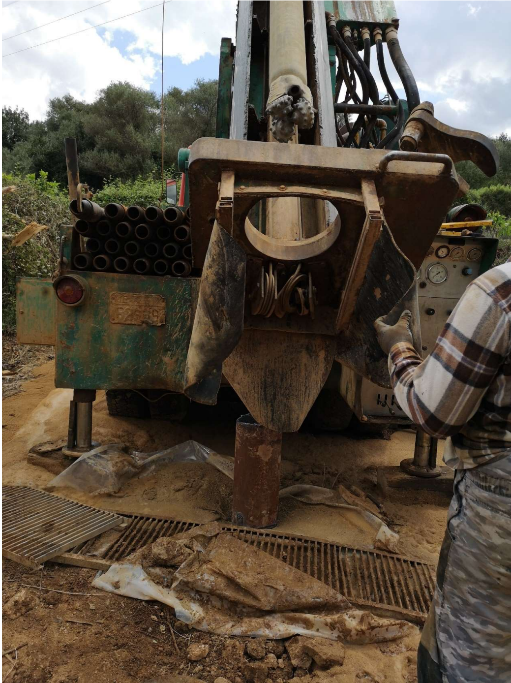
Λόγο μεγάλης πίεσης η οποία ασκήθηκε στο κοπτικό έσπασε το ρουλεμάν οπού ο γερανός βύθιζε το κοπτικό στην γεώτρηση.
