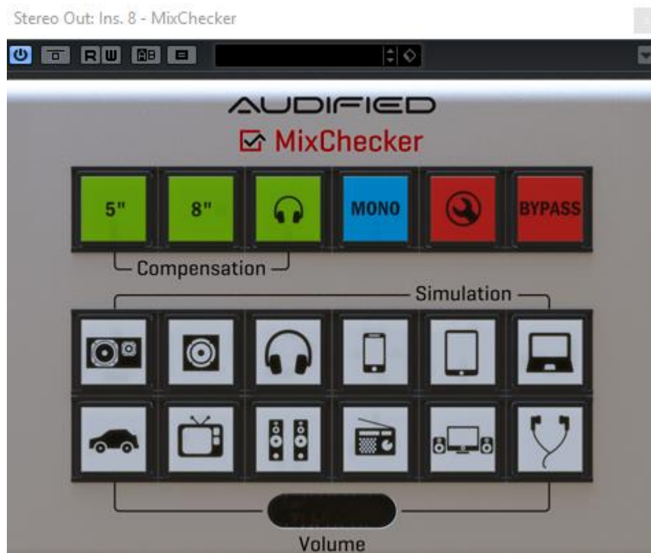
ΕΙΚ. 22: ΤΟ MIXCHECKER ΤΗΣ AUDIFIED. ΧΡΗΣΙΜΟΠΟΙΗΘΗΚΕ ΓΙΑ ΝΑ ΑΚΡΟΑΣΤΟΥΜΕ ΠΩΣ ΘΑ ΑΚΟΥΣΤΕΙ ΤΟ ΚΟΜΜΑΤΙ ΣΕ ΔΙΑΦΟΡΕΣ ΣΥΣΚΕΥΕΣ.
