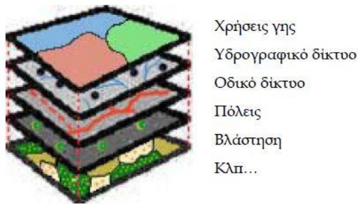
Εικόνα 2: Σύστημα GIS. Απεικονίζει και αναλύει δεδομένα σε επίπεδα στον ίδιο αγρό. Κάθε επίπεδο μπορεί να περιέχει πληροφορίες που αφορούν ένα από τα επόμενα (Χαλκιάς, 2011)
