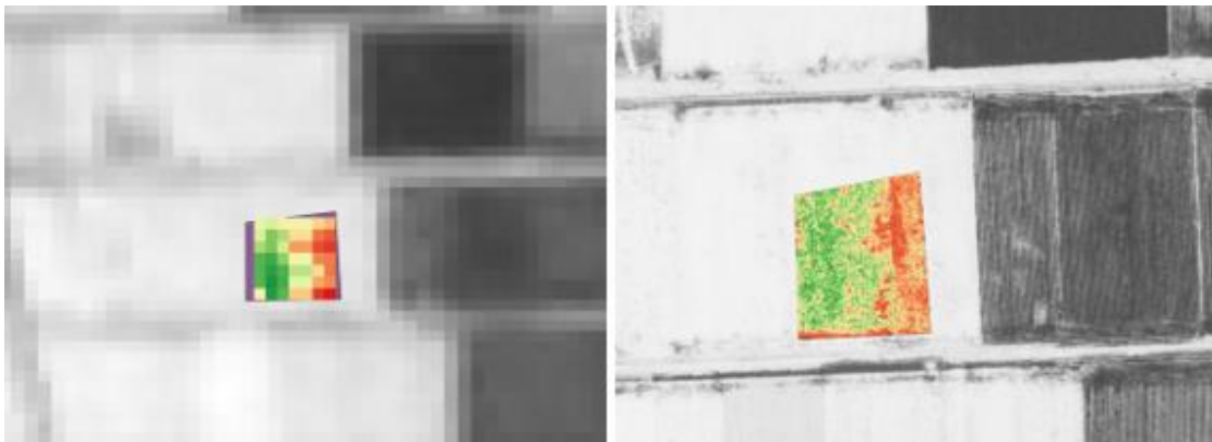
Εικόνα 105: Αποτύπωση της περιοχής B σε κλίμακα 1:1000 στα δεδομένα από δορυφόρο (αριστερά) και από πολυφασματική κάμερα (δεξιά)
