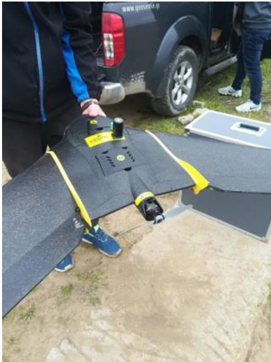
Εικόνα 18: Το αερόχημα eBee SQ και η πολυφασματική κάμερα Parrot Sequoia Plus
