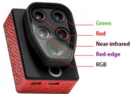
Εικόνα 18: Το αερόχημα eBee SQ και η πολυφασματική κάμερα Parrot Sequoia Plus
