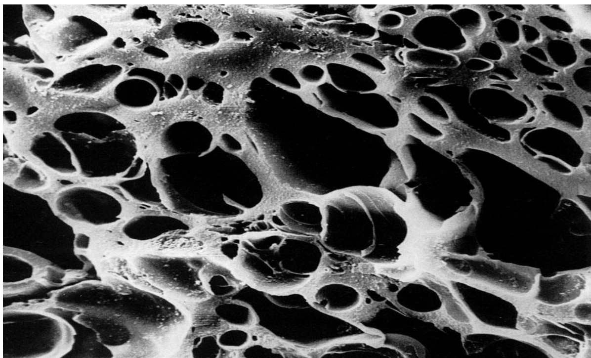
Σχήμα 3.4 Δομή ενεργού άνθρακα σε ηλεκτρονικό μικροσκόπιο, όπου διακρίνονται οι μικροσκοπικοί πόροι [58]
