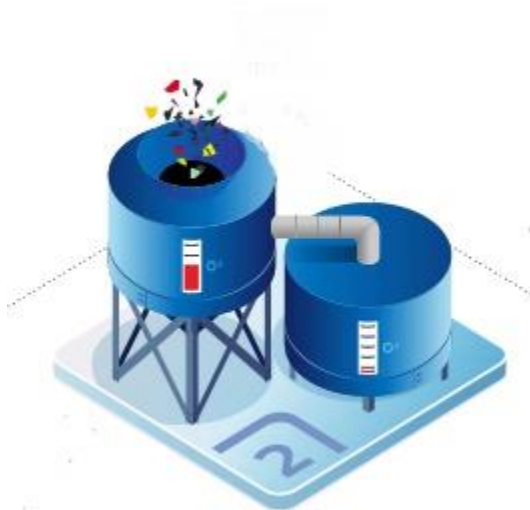
Εικόνα 3 Σκίτσο αναπαράστασης σιλό αφαίρεσης οξυγόνου
