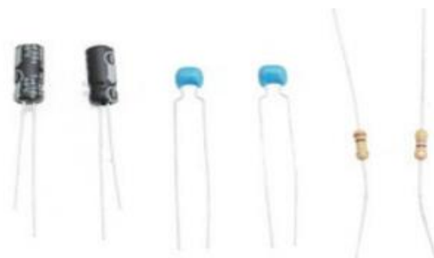
Σχήμα 5.1.16: α) Πίνακας παθητικών στοιχείων β) Ηλεκτρολυτικοί και κεραμικοί πυκνωτές, αντιστάσεις.
