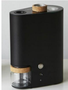
Εικόνα 22 : IKAWA (Συσκευή καβουρδίσματος δειγμάτων καφέ)
