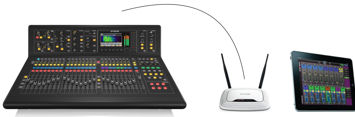
Σχ. 7.5 Σύνδεση Ψηφιακής Κονσόλας με Router και Tablet.
