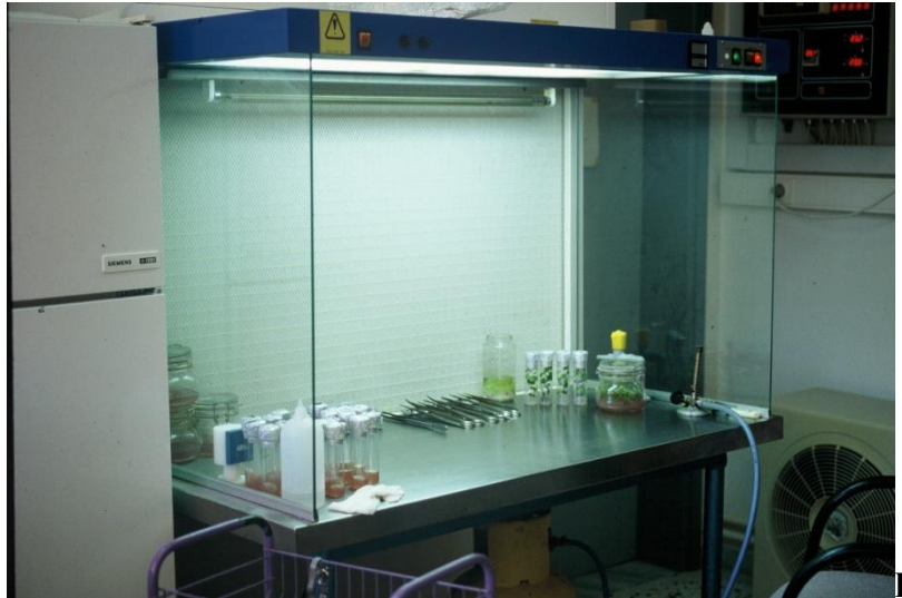
Εικόνα 16: Α) Η αφαίρεση των εξωτερικών φύλλων από παραφυάδα αλόης και δημιουργία μακρο-έκφυτου, Β) Η απολύμανση των μακρο-εκφύτων αλόης, Γ) Θάλαμος οριζόντιας νηματικής ροής.
