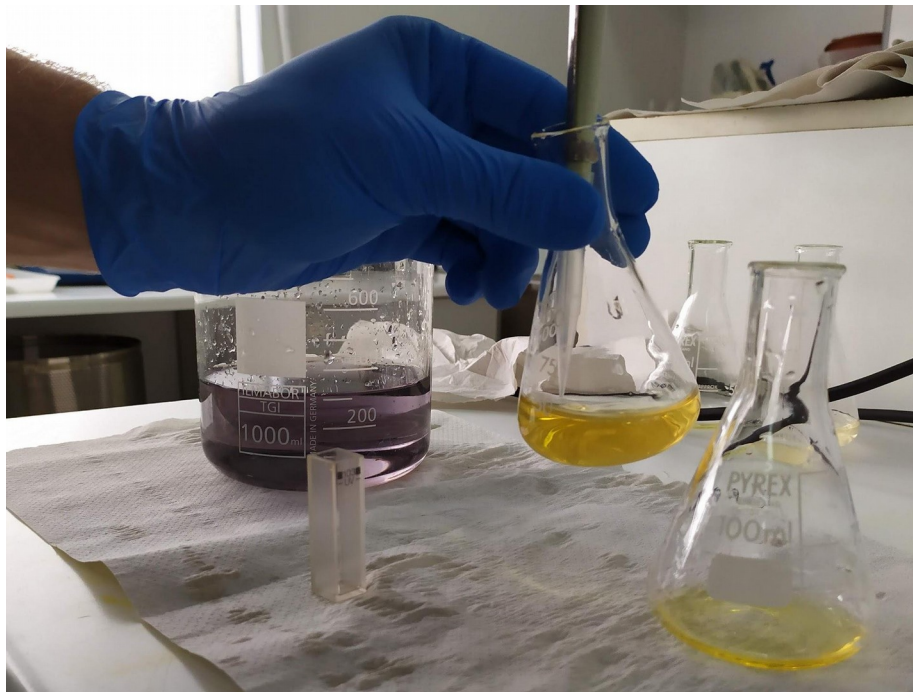
Εικόνα 2.7: Προσθήκη 0,5 ml δ/τος του προσδιοριζόμενου μελιού, σε 5 ml δ/τος ιωδίου για λήψη απορρόφησης (Blank).
