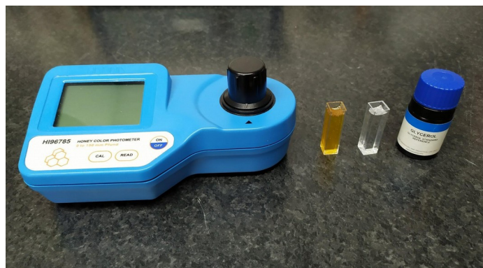
Εικόνα 2.2: Συσκευή μέτρησης του χρώματος του μελιού σε κλίμακα Pfund, κυψελίδες με μέλι και γλυκερόλη.
